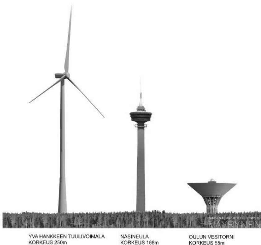
Kuva 10. Tuulivoimaloiden suhde muuhun korkeaan rakentamiseen. Maanpinnalle on havainnollisuuden takia mallinnettu noin 20-metrinen puusto.
